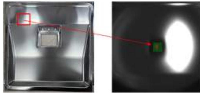
Fig. 2. 이미지 차분 기반 결함 Pixel 및 배경 Pixel 그룹화
